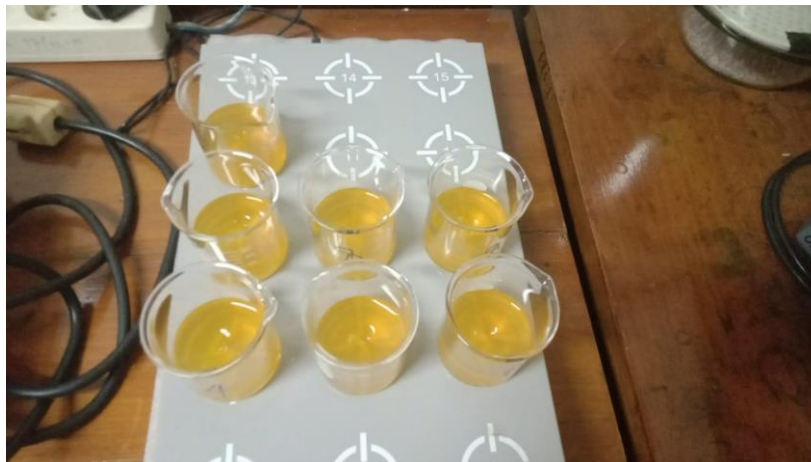
Proses Pengadukan Menggunakan Magnetic Stirrer
