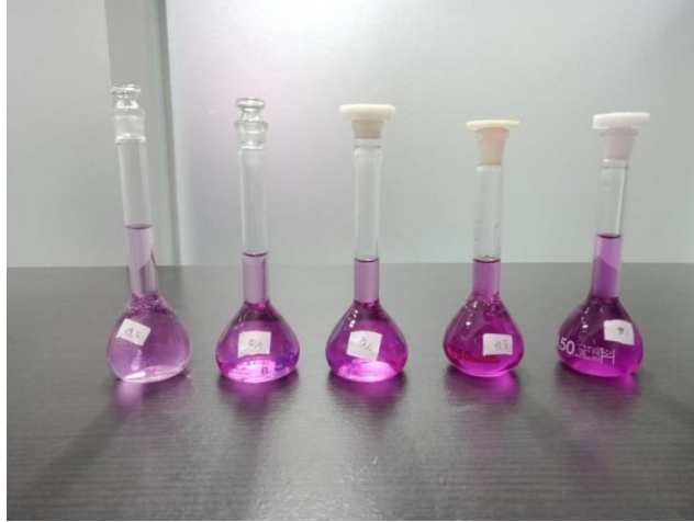
Pembuatan Deret Standar Krom(VI)
