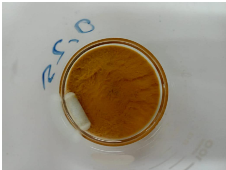
Flok Hasil Pengadukan Sampel dengan Penambahan Koagulan
