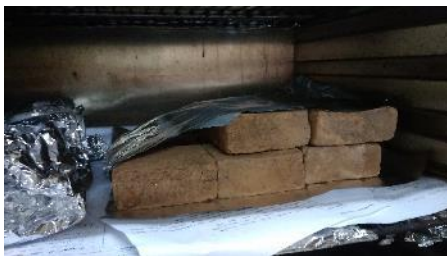
- Rangkaian Uji Kerapatan Semu dan Uji Penyerapan Air
