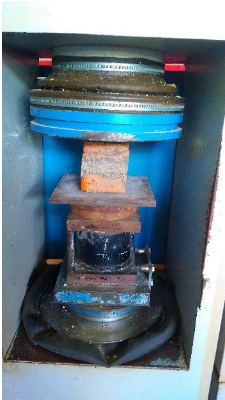
- Rangkaian Uji Kerapatan Semu dan Uji Penyerapan Air
