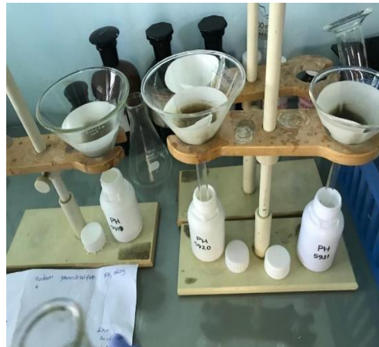
Disaring dengan kertas whattman dan dimasukkan kedalam botol sampel kemudian siap dianalisis menggunakan ICP-OES
