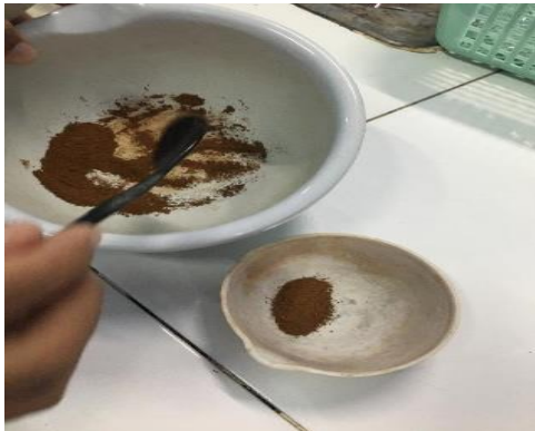
Sedimen dihaluskan di masukkan ke dalam cawan porselen untuk dilakukan penimbangan
