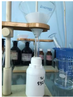
Sampel disaring menggunakan kertas whattman kedalam botol sampel
