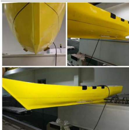
Gambar I.2 Pemasangan Bilge Keel dengan sudut kemiringan 30^\circ
