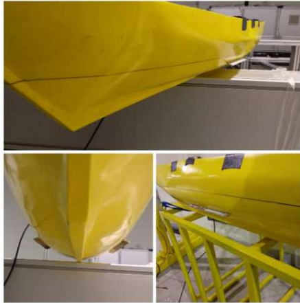
Gambar I.1 Pemasangan Bilge Keel dengan sudut kemiringan 15^\circ
