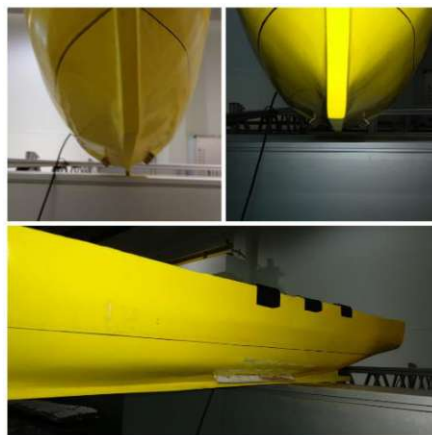
Gambar I.3 Pemasangan Bilge Keel dengan sudut kemiringan 45^\circ
