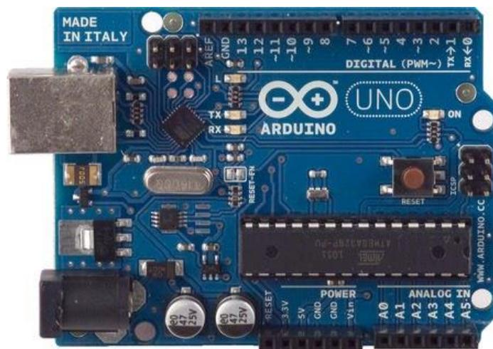
Gambar 2. 11 Mikrokontroler Arduino Uno
