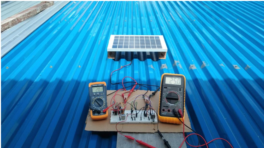
Lampiran 8 Tegangan Output Prototipe Buck-Boost Converter pada Mode Boost
