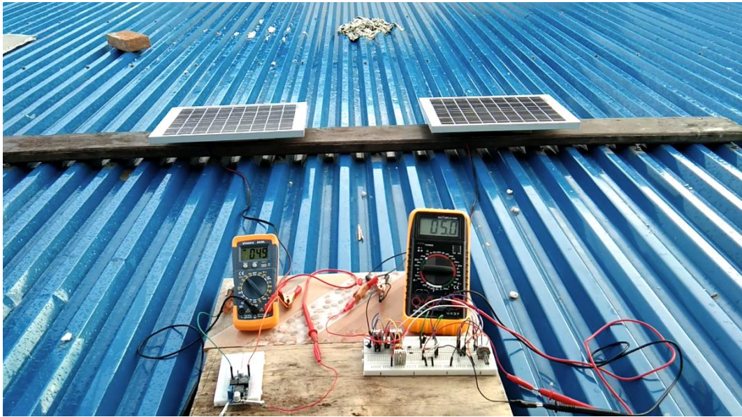
Lampiran 17 Pengujian Rancangan Buck-Boost Converter dan Buck-Boost Converter Pasaran dengan Durasi 10 Menit
