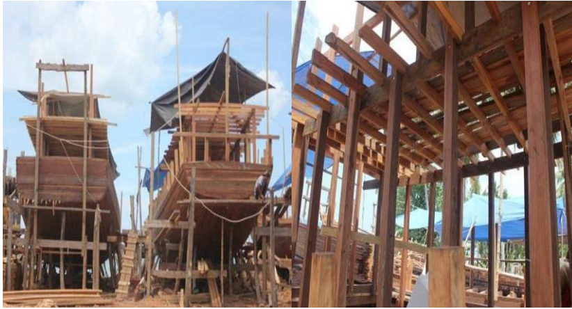
Gambar 3 Proses pembuatan kapal phinisi dengan kayu bitti di PT Semesta Phinisi Bulukumba, Kab. Bulukumba, Sulawesi Selatan (foto: M. Siarudin)
