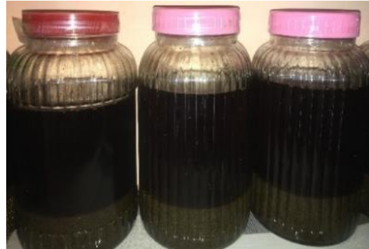
Proses maserasi menggunakan pelarut n -heksan lalu remaserasi etanol 70%
