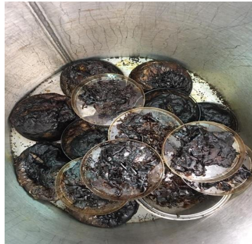
Ekstrak kering yang telah di Freeze drying
