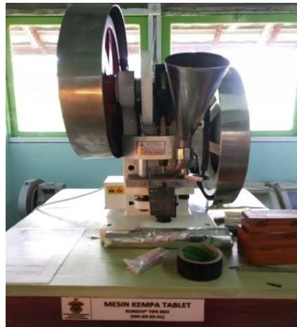
Alat pencetak tablet (Single Punch Tablet Press Korsch ® tipe Eko )
