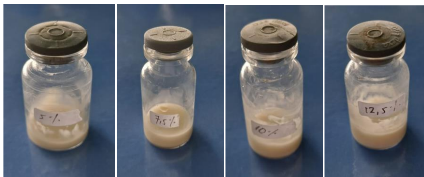
Gambar 22. Pengujian tipe emulsi metode pengenceran
