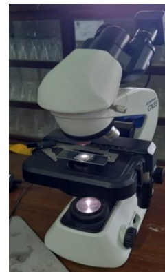
Gambar 19. Pengukuran distribusi ukuran partikel menggunakan mikroskop
