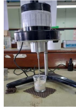
Gambar 17. Pengukuran viskositas sediaan krim
