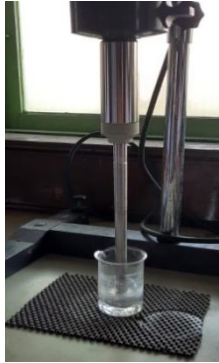
Gambar 16. Proses pencampuran fase air dan fase minyak
