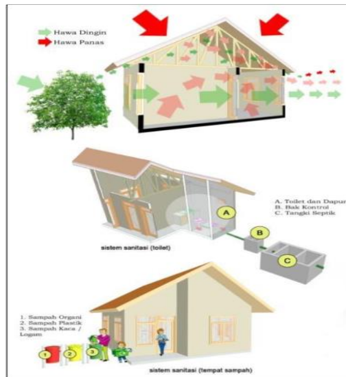
Gambar 2.5 Penggambaran Aspek Keselamatan Bangunan
