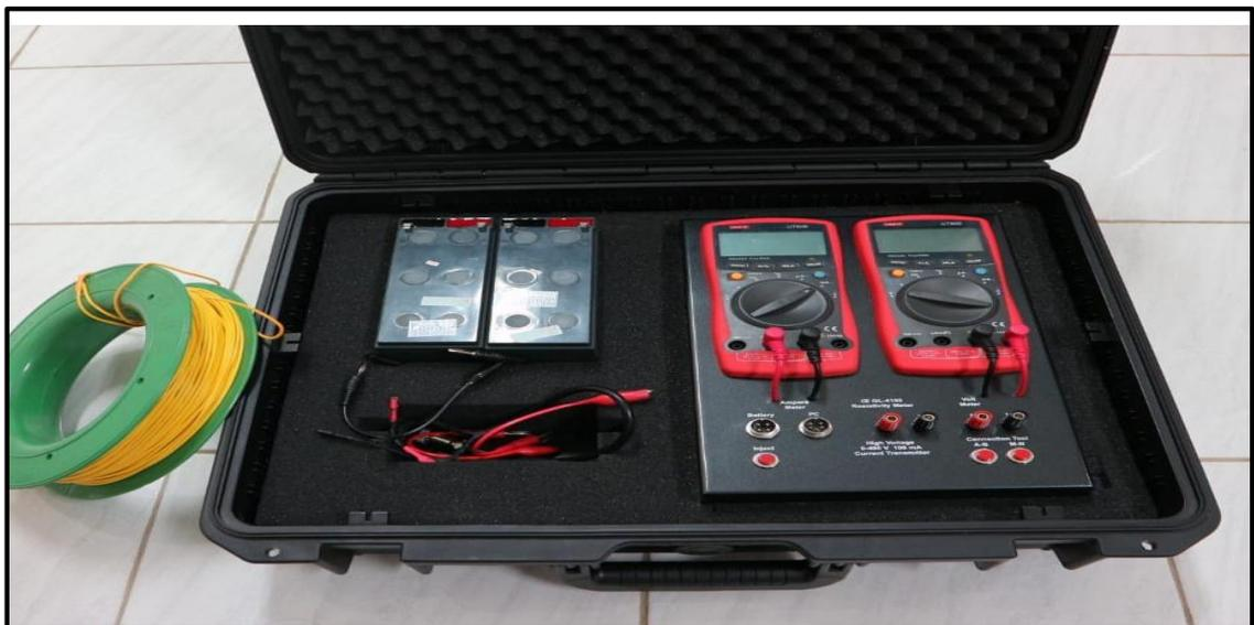
Gambar 2.12 Alat Pengukur Resistivitas Batuan
