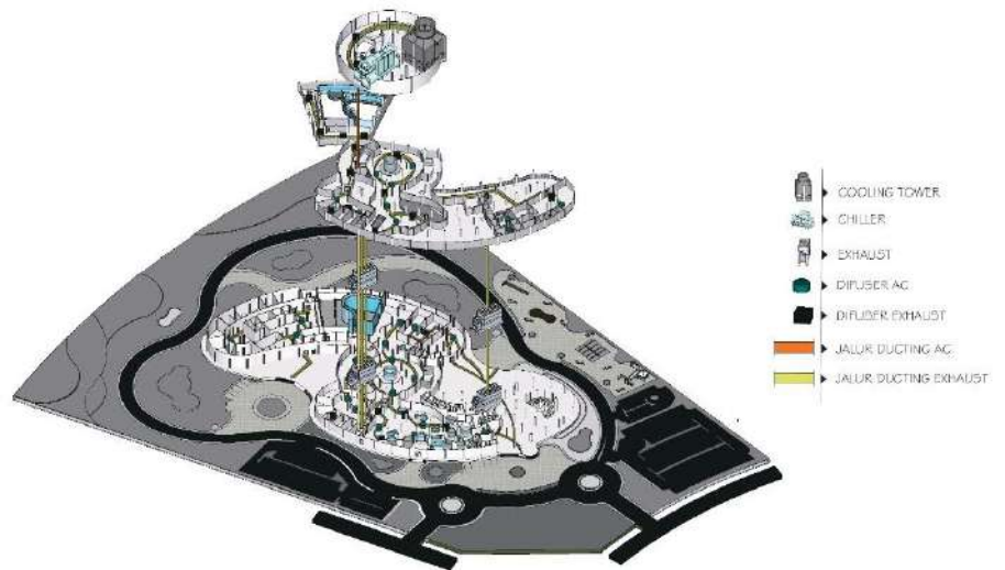
Gambar 11 Isometri Jaringan Penghawaan
