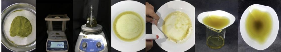
Gambar A. Serbuk daun kelor ( Moringa oleifera ) disaring, B. Serbuk daun kelor ( Moringa oleifera ) ditimbang, C. Larutan daun kelor ( Moringa oleifera ) disentrifugasi, D. Filtrat nanopartikel daun kelor ( Moringa oleifera ) diletakkan di piring ceper, E. Pemisahan filtrat nanopartikel daun kelor ( Moringa oleifera ) setelah proses penguapan etanol, F. Presipitasi menggunakan Whatman filter paper no. 42, G. Pemisahan nanopartikel daun kelor ( Moringa oleifera ) dengan air pelarut
