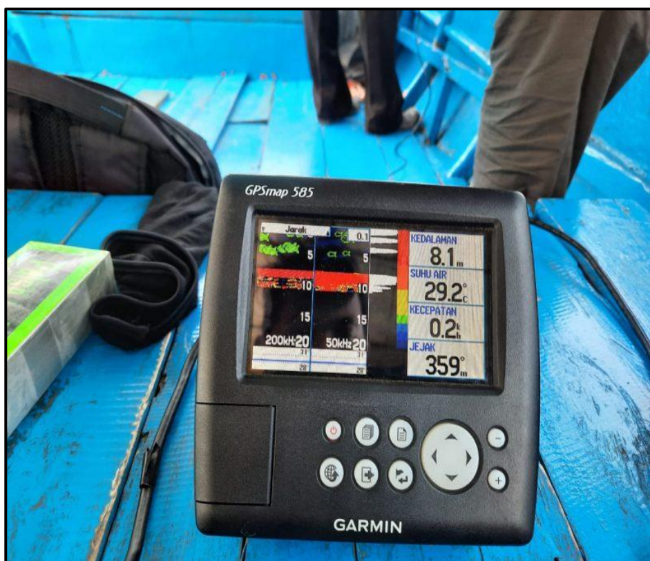
Gambar 2.4 Alat perum gema ( echosounder ) tipe GPSmap 585 yang digunakan dalam pengukuran batimetri pada lokasi penelitian.
