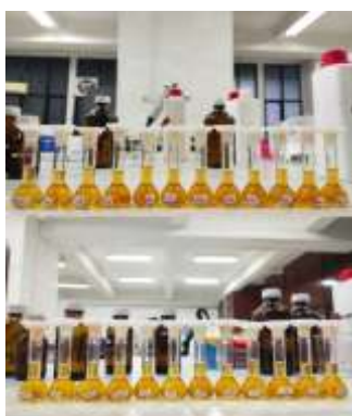
Gambar 13. Pengukuran kadar Antosianin dengan buffer pH 1
