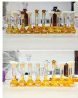
Gambar 14. Pengukuran kadar Antosianin dengan buffer pH 4,5
