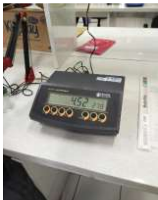
Gambar 11. Pengukuran buffer pH 4.5
