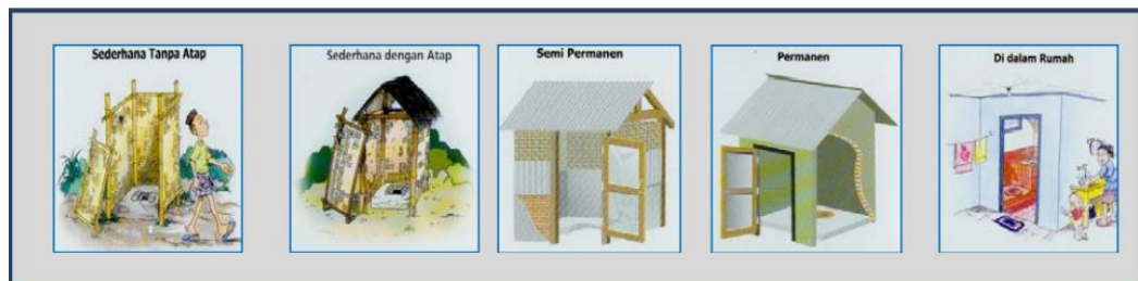
Gambar 2.1. Bangunan bagian atas jamban
