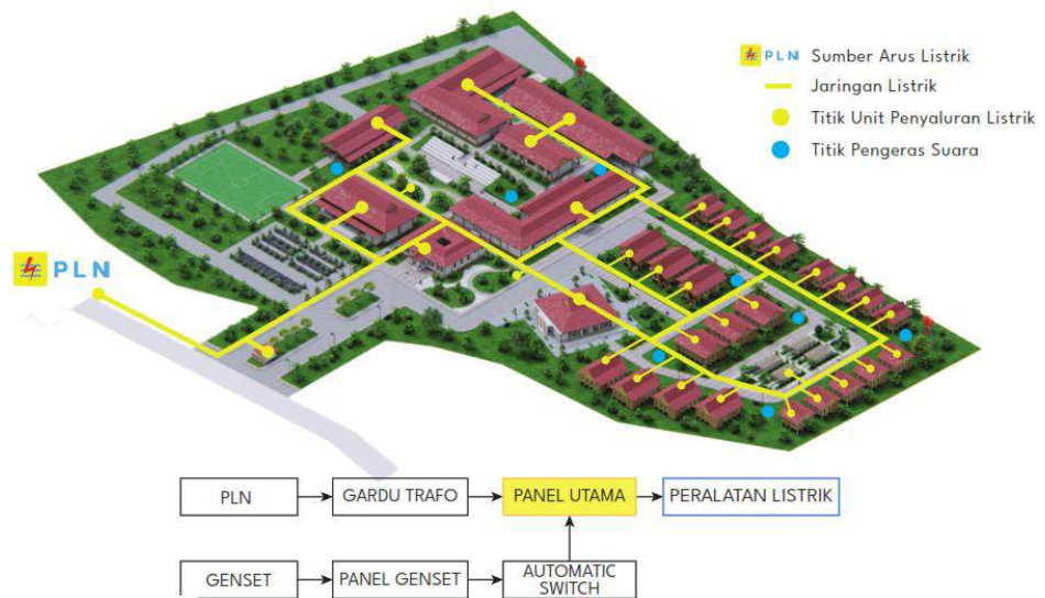
Gambar 9 Sistem Jaringan Listrik dan Komunikasi
