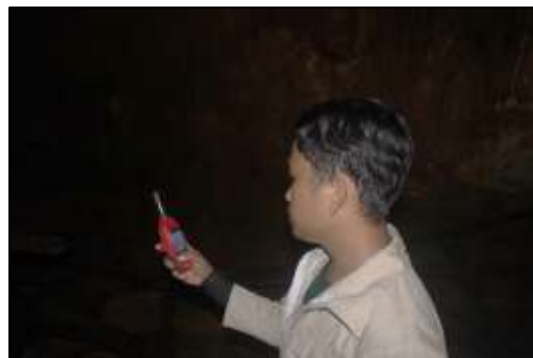
(d) Pengukuran suhu dan kelembaban dengan Temperature/Humidity Meter
