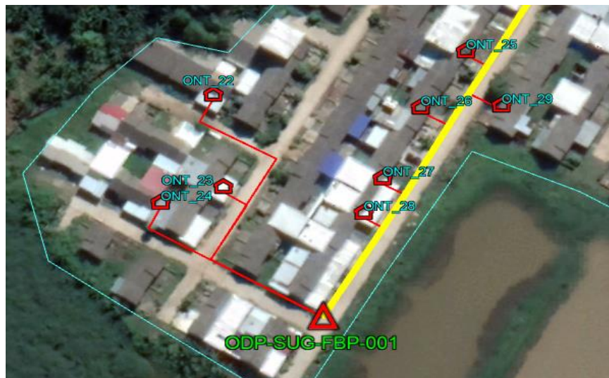
Gambar III. 6 Pemetaan Jalur Drop Pada ODP-SUG-FBP-001
