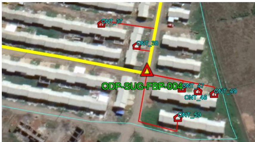
Gambar L. II. 3 Pemetaan Jalur Kabel Drop pada ODP-SUG-FBP-004
