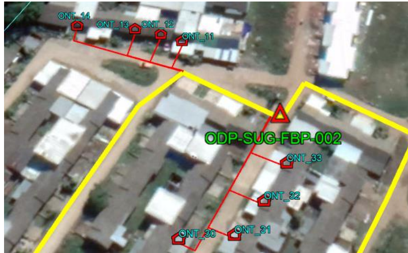
Gambar L. II.1 Pemetaan Jalur Kabel Drop pada ODP-SUG-FBP-002
