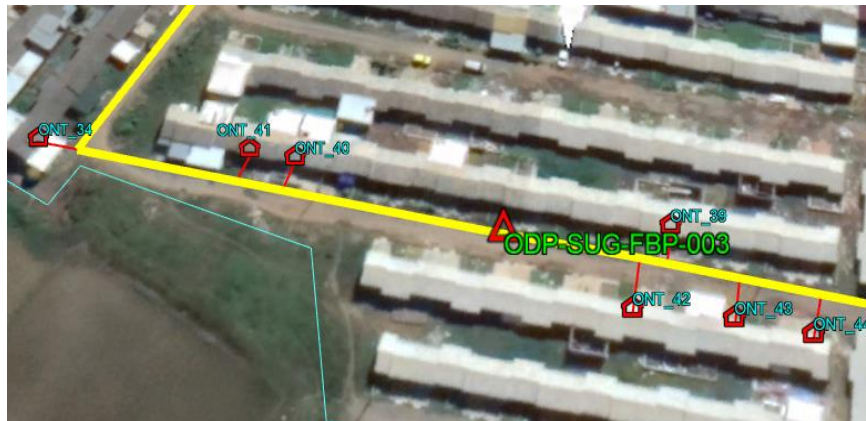
Gambar L.II.2 Pemetaan Jalur Kabel Drop pada ODP-SUG-FBP-003
