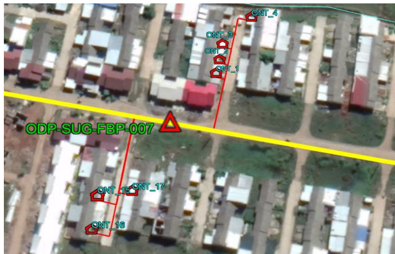
Gambar L. II. 6 Pemetaan Jalur Kabel Drop pada ODP-SUG-FBP-007
