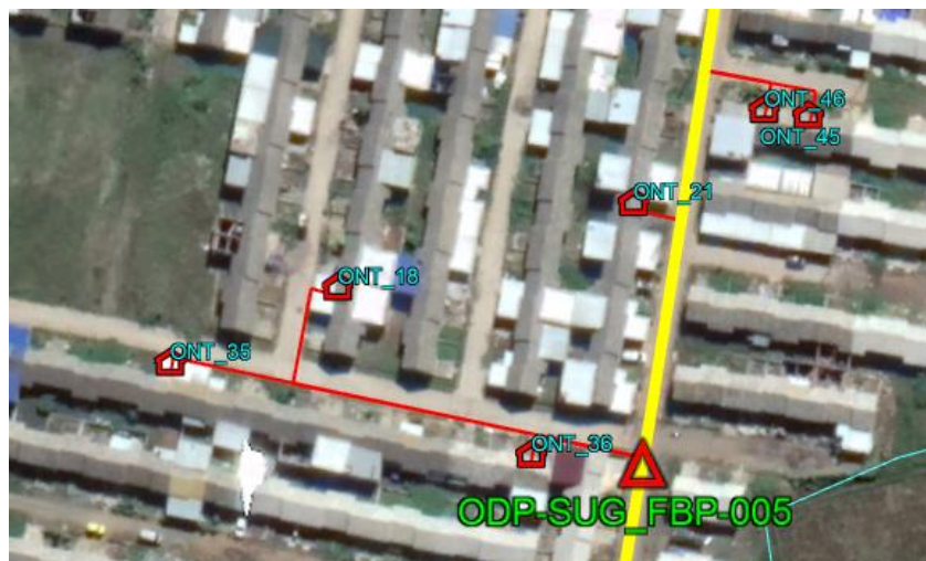
Gambar L. II. 4 Pemetaan Jalur Kabel Drop pada ODP-SUG-FBP-005
