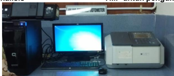
Gambar 18. Pengukuran kadar MDA dengan spektrofotometer UV-Vis
