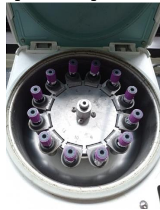
Gambar 15. Sentrifugasi sampel organ otak tikus
