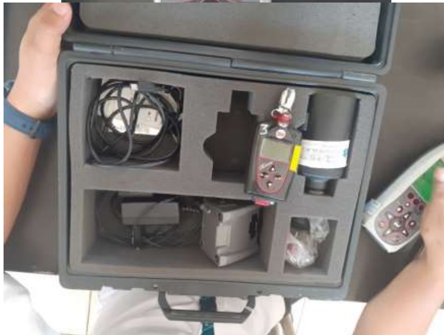
Dokumentasi alat sound level meter pro SE/DL dan sound level meter personal
