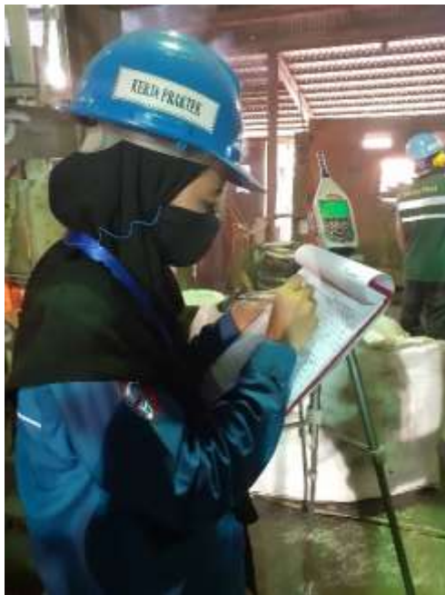
Pengukuran Kebisingan di area ore preparation PT. ANTAM Tbk. Unit Bisnis Pertambangan Nikel Kota Pomalaa, Sulawesi Utara.
