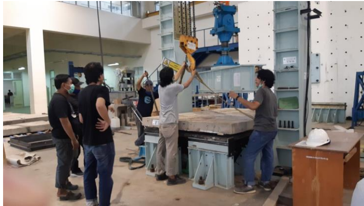
Proses Peletakan Benda Uji ke Static
