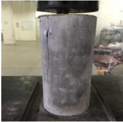
Pengujian Kuat tekan Beton
