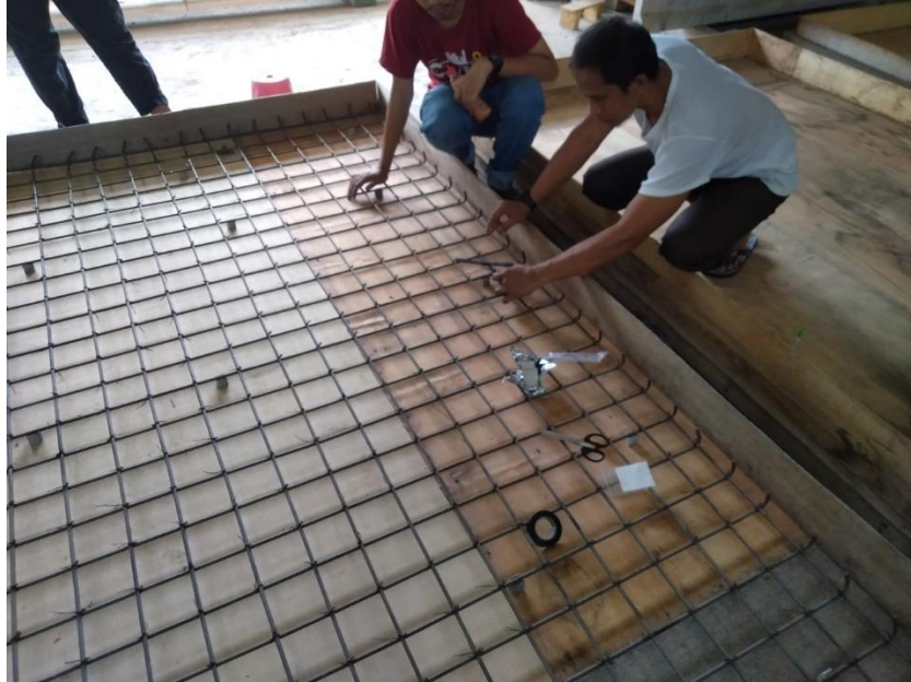
Pemasang Strain Gauge Baja Pelat Pejal
