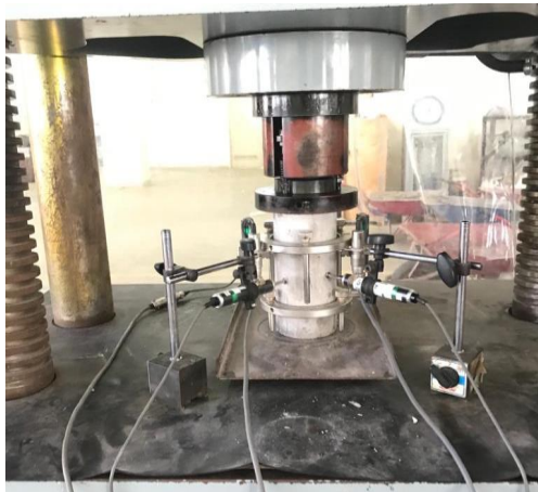
Pengujian Elastisitas Beton
