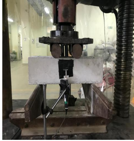
Pengujian Kuat Lentur Beton
