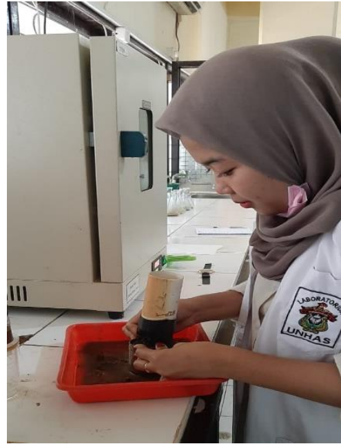
Pemasangan Pipa Paralon untuk Pengujian Permeabilitas Tanah
