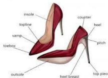
Gambar 2.1 Bagian-bagian high heels (Sumber: Gephart, 2017)
