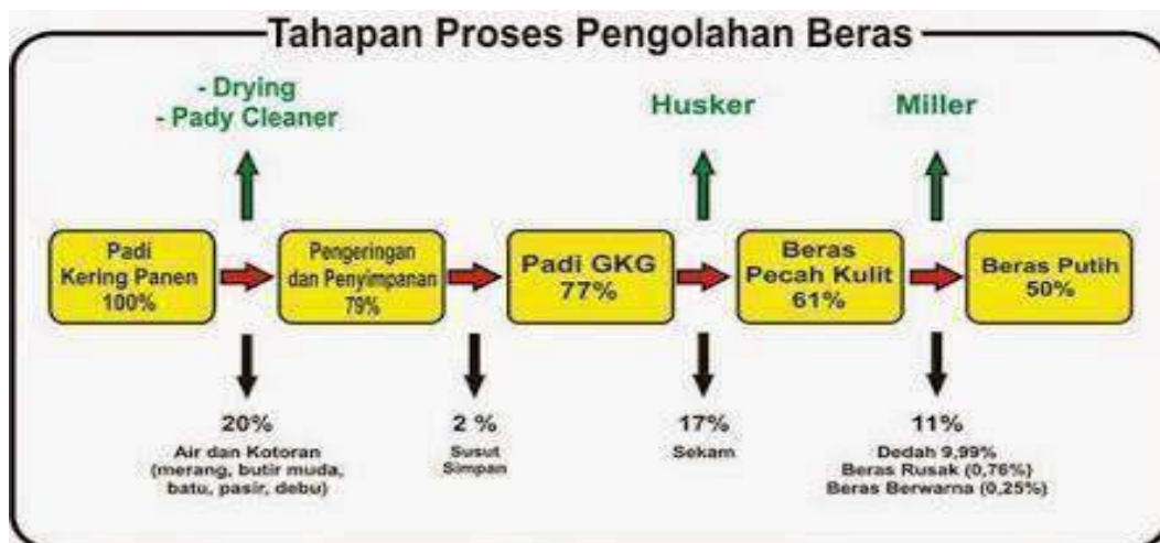
Gambar 1. Tahapan Proses Pengolahan Beras
