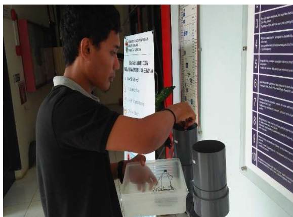
Memasukkan sampel ke alat pengering tipe batchdryer
