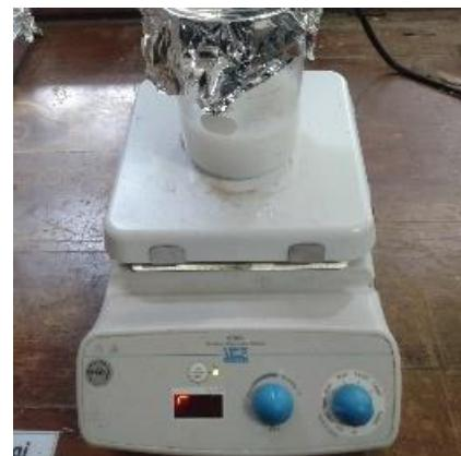
Stirrer  $(\text{Ca}(\text{OH})_2) + (\text{NH}_4)_2\text{HPO}_4 + \text{aquades}$
