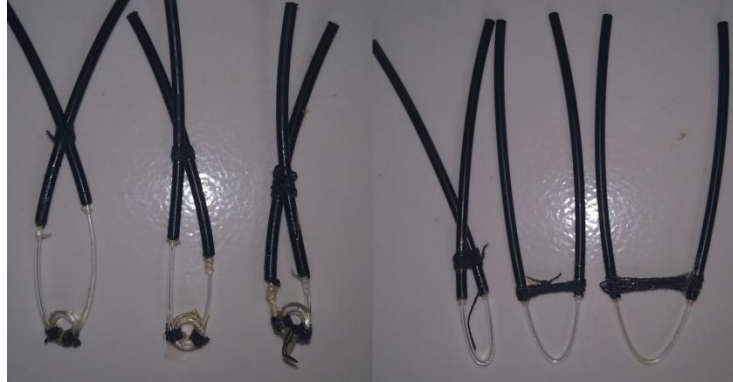
Lampiran 7. Foto sensor serat optik konfigurasi U dan konfigurasi spiral spring dengan selubung kitosan
