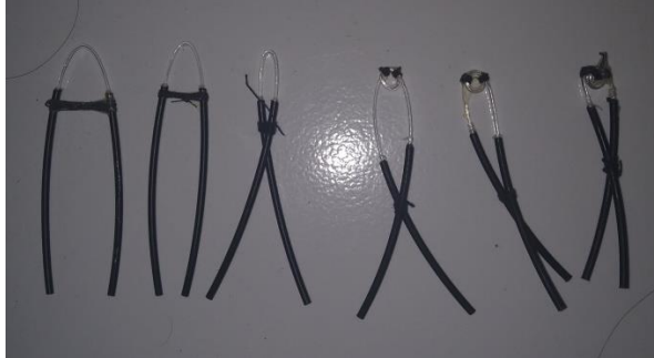
Lampiran 4. Foto sensor serat optik konfigurasi U dan konfigurasi spiral spring tanpa selubung kitosan
