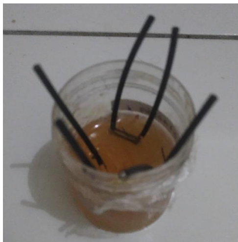
Lampiran 6. Foto proses pelapisan sensor dengan kitosan sebagai selubung
