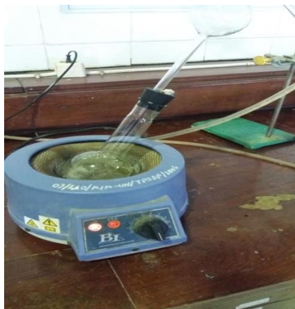
Proses destruksi (Analisis kadar protein metode Kjeldahl)
