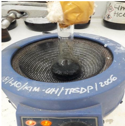
Proses destruksi (Analisis kadar protein metode Kjeldahl)
