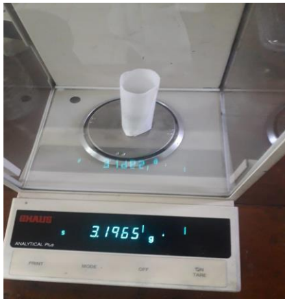
Proses penimbangan (Analisis kadar lemak metode soxlet )
