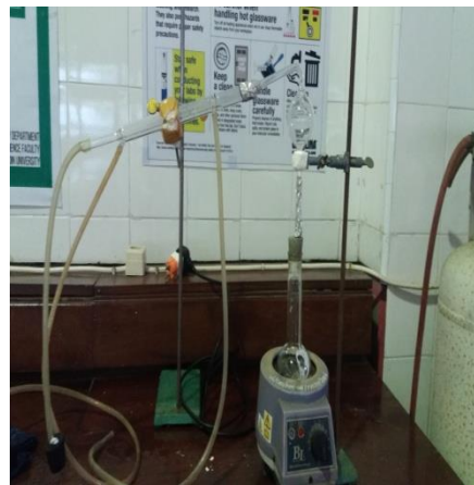
Hasil Destilasi (Analisis kadar protein metode Kjeldahl)
