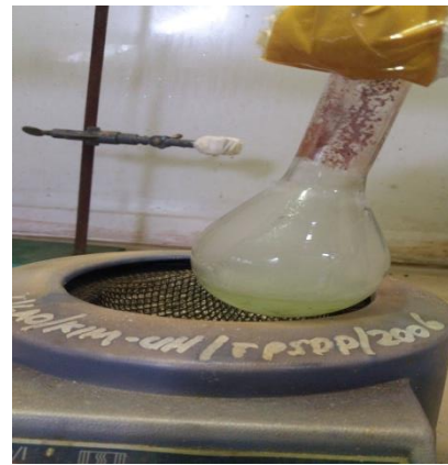
Hasil Destilasi (Analisis kadar protein metode Kjeldahl)
