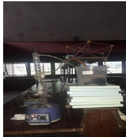
Proses soxletasi (Analisis kadar lemak metode soxlet )
