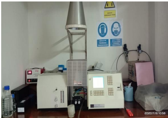
Analisis Data menggunakan Alat Spektrofotometer Serapan Atom (SSA)
