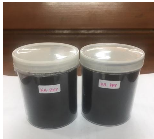
Gambar 6. Karbon Aktif Pelepah Kelapa Sawit setelah dikeringkan
