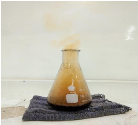
Gambar 7. Modifikasi Karbon Aktif dengan H_2SO_4
