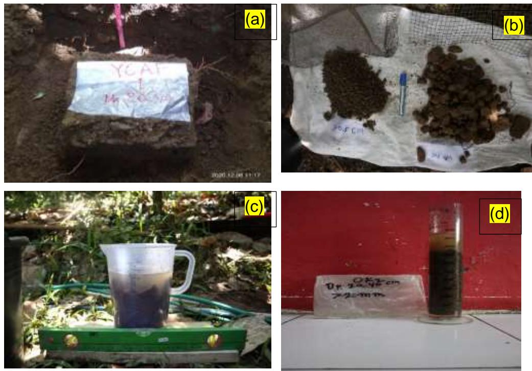
**Gambar 2.1.**(a) Pengambilan sampel tanah berukuran 20 cm x 20 cm x 20 cm untuk mengukur kerapatan isi tanah berbatu; (b) kandungan batu dalam tanah berbatu; (c dan d) pengukuran volume batu setelah dipisahkan dengan fraksi tanah
