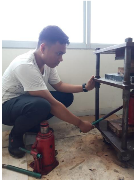
Gambar 3. Proses Press Hidrolik Material Komposit
