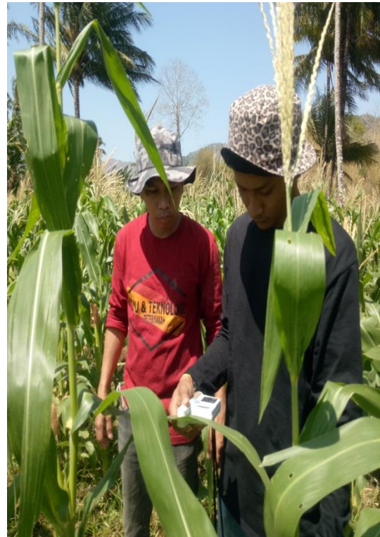
Gambar 7. Mengukur Klorofil Daun Menggunakan Alat Konica Minolta Chlorophyll Meter SPAD-502 Plus
