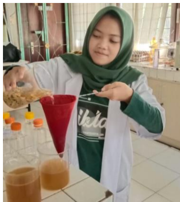
Proses penyaringan larutan yang telah menjadi gelatin cair
