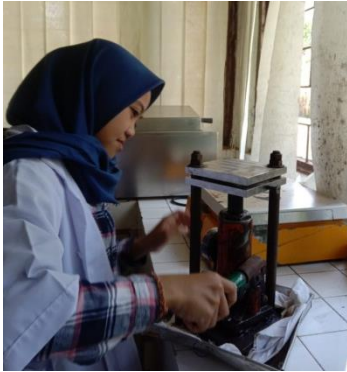
Proses pengujian daya ikat air bakso menggunakan filter papper press
