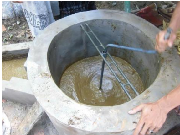
Gambar 2. 1 Pengadukan Kotoran Ternak Untuk Biogas (Oktavia and Firmansyah 2017).
