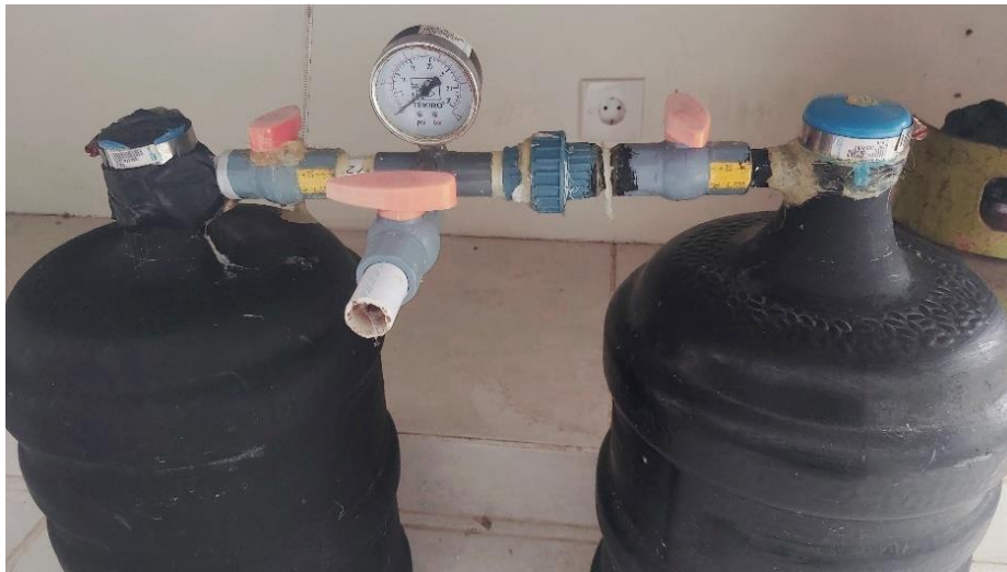
Gambar 2. 4 Biodigester kapasitas 19 L dalam satu reaktor
