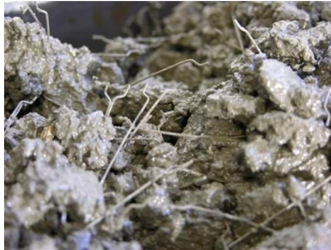
Gambar 1. Campuran beton dengan serat baja
