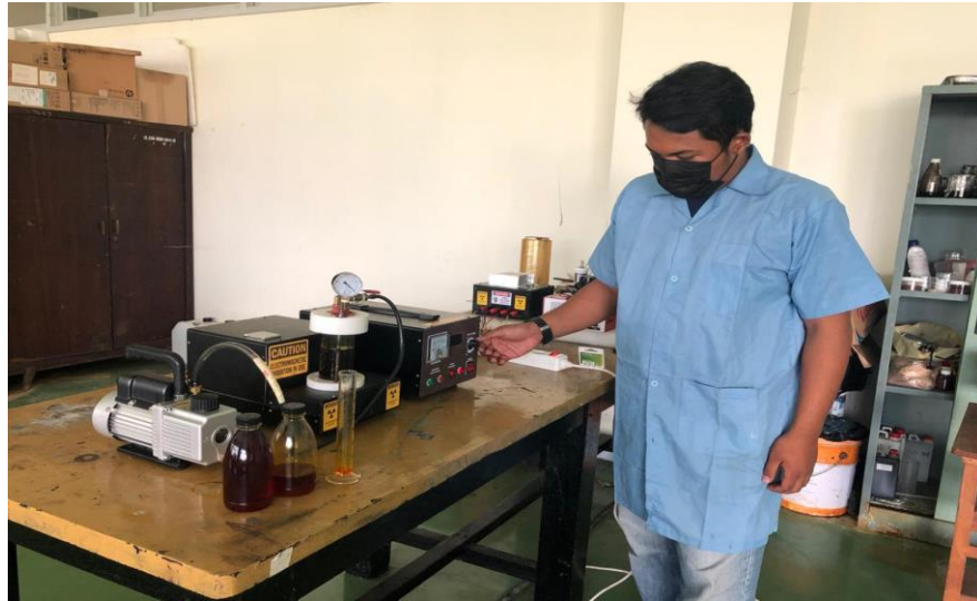
Lampiran 1. Proses plasma pada minyak sawit.
