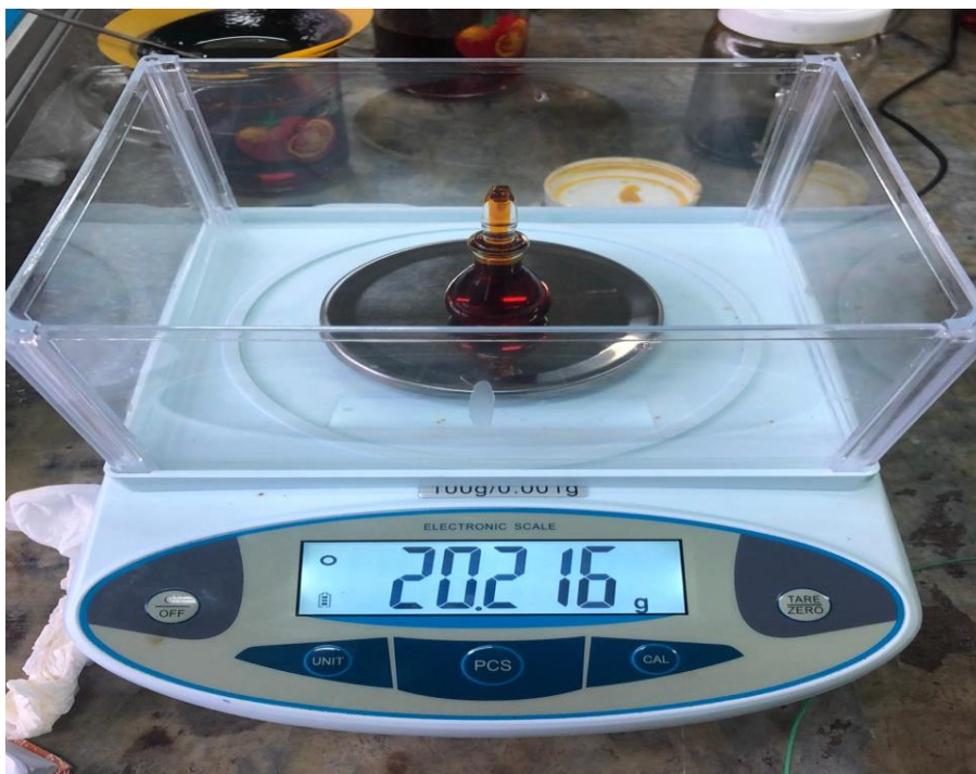
Lampiran 3. Proses pengujian Densitas (massa jenis) minyak sawit
