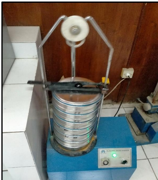
Pengayakan dan penimbangan sampel sedimen
