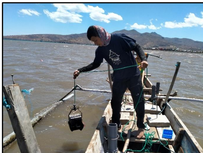
Pengambilan sampel sedimen dasar dengan menggunakan Van Veen Grab
