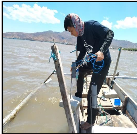
Peletakan Sedimen Trap dan pengambilan sampel
