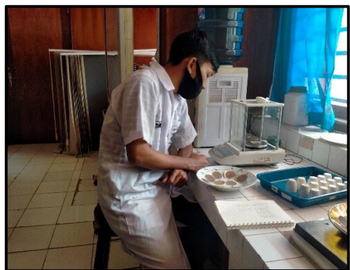
Penimbangan hasil yang telah di keringkan menggunakan Oven
