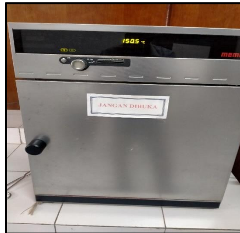
Pengeringan sampel sedimen menggunakan Oven
