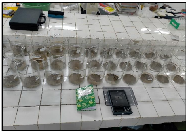
Penimbangan hasil yang telah di oven.
