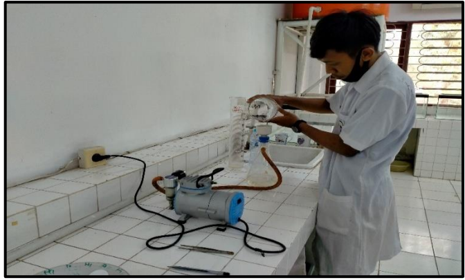
Penyaringan sampel menggunakan Vacuum pump
