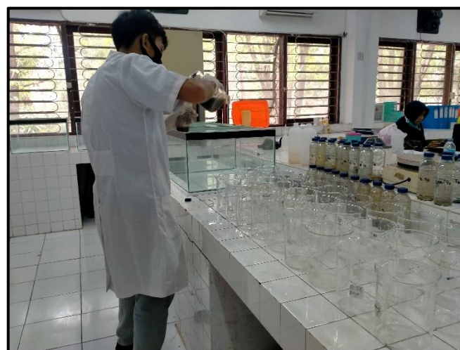
Penuangan sampel sedimen trap di dalam gelas kimia 1000 ml
