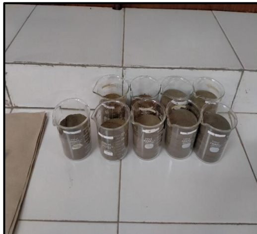
Pengeringan sampel sedimen menggunakan Oven
