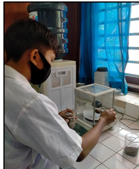
Pengayakan dan penimbangan sampel sedimen
