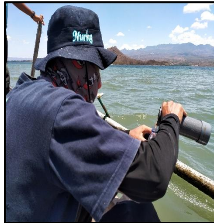
Peletakan Sedimen Trap dan pengambilan sampel
