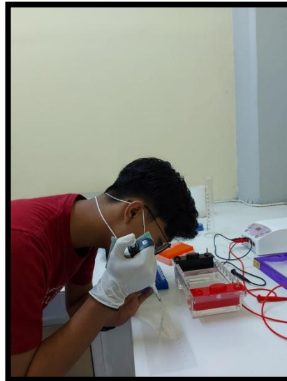
Keterangan : Memasukkan sampel ke dalam gel
