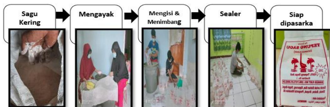
Gambar 18 Proses pengemasan sagu kering
