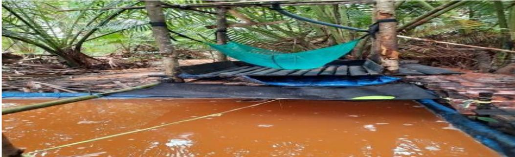
Gambar 15 Pengendapan pati sagu menggunakan terpal
