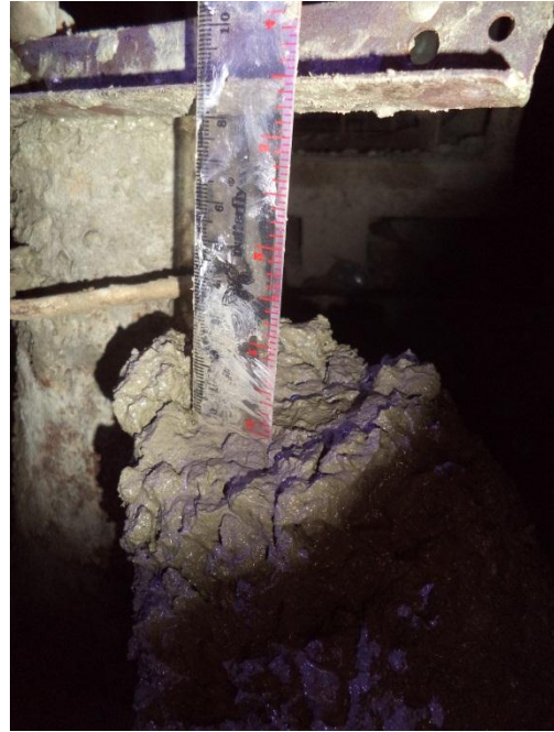
Pemeriksaan slump. Pengukuran menggunakan mistar (kanan)
