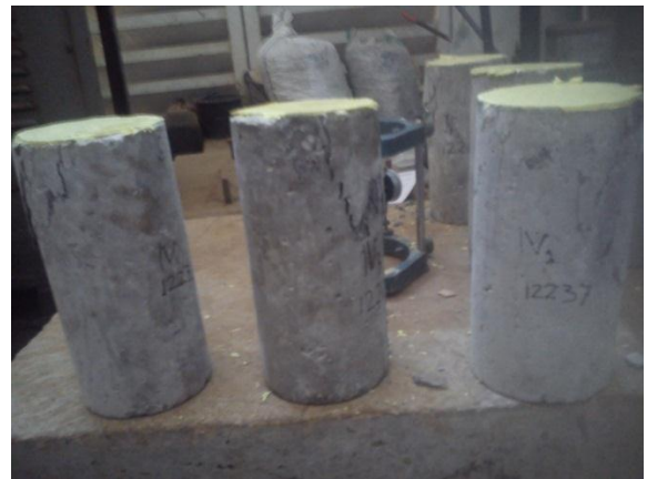
Pola retak Beton Mix 4 pada umur 28 hari (kiri) dan umur 91 hari (kanan)
