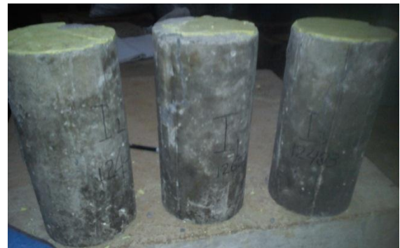
Pola retak Beton Mix 1 pada umur 28 hari (kiri) dan umur 91 hari (kanan)
