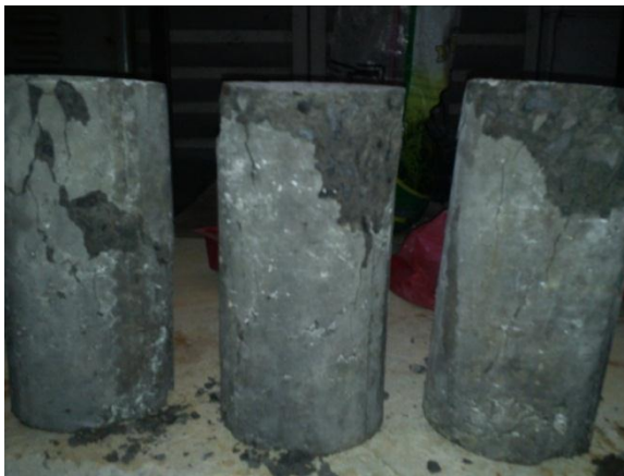
Pola retak Beton Mix 4 pada umur 28 hari (kiri) dan umur 91 hari (kanan)
