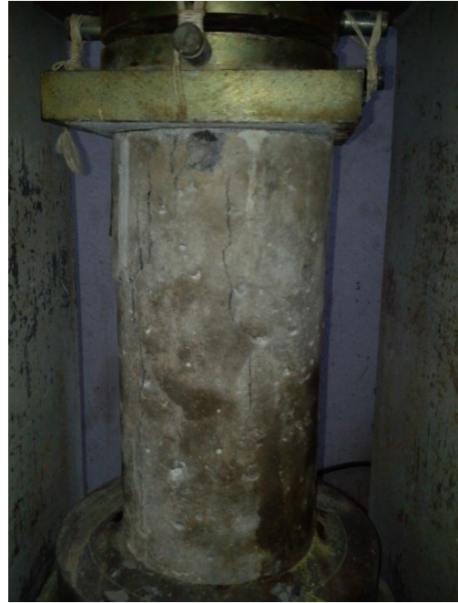
Pengujian kuat tekan beton menggunakan Universal Testing Machine (kiri) sampai beton mengalami keruntuhan (kanan)
