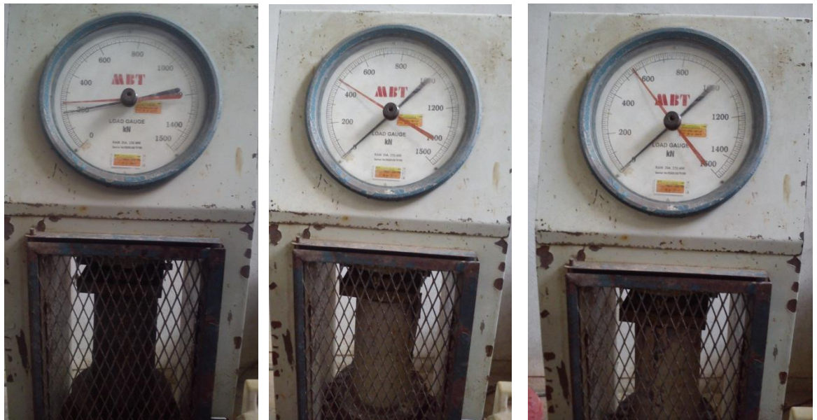
Pengujian Beton Mix 3 hari ke-3 (kiri), hari ke-14 (tengah), dan hari ke-28 (kanan)
