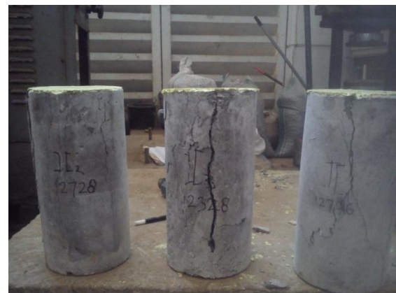
Pola retak Beton Mix 2 pada umur 28 hari (kiri) dan umur 91 hari (kanan)
