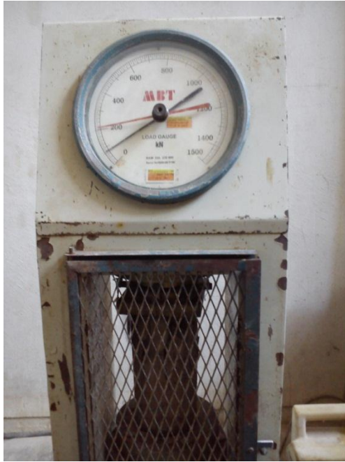
Pengujian kuat tekan beton menggunakan Universal Testing Machine (kiri) sampai beton mengalami keruntuhan (kanan)
