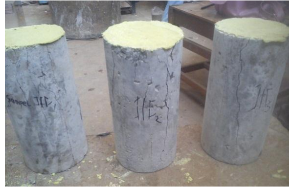
Pola retak Beton Mix 3 pada umur 28 hari (kiri) dan umur 91 hari (kanan)
