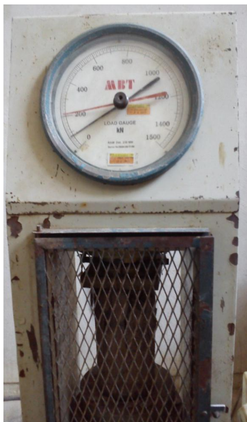
Gambar 4.4 Pengujian Kuat Tekan Beton
