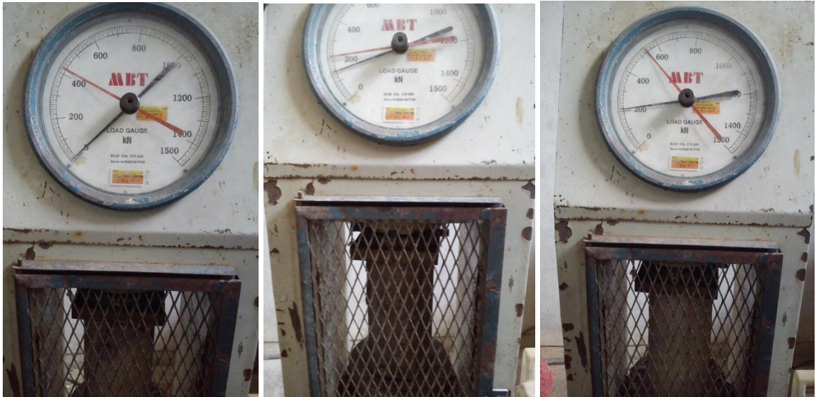
Pengujian Beton Mix 4 hari ke-3 (kiri), hari ke-14 (tengah), dan hari ke-28 (kanan)
