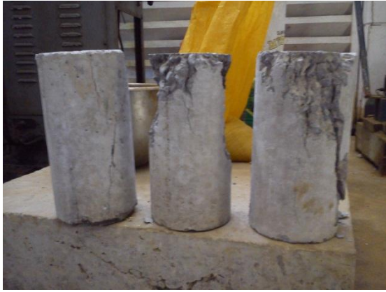
Pola retak Beton Mix 3 pada umur 28 hari (kiri) dan umur 91 hari (kanan)
