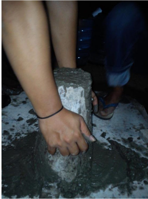
Pemeriksaan slump. Pengukuran menggunakan mistar (kanan)
