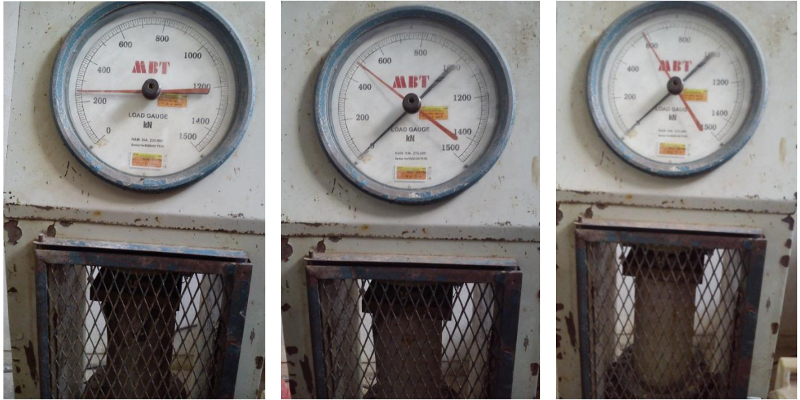
Pengujian Beton Mix 2 hari ke-3 (kiri), hari ke-14 (tengah), dan hari ke-28 (kanan)
