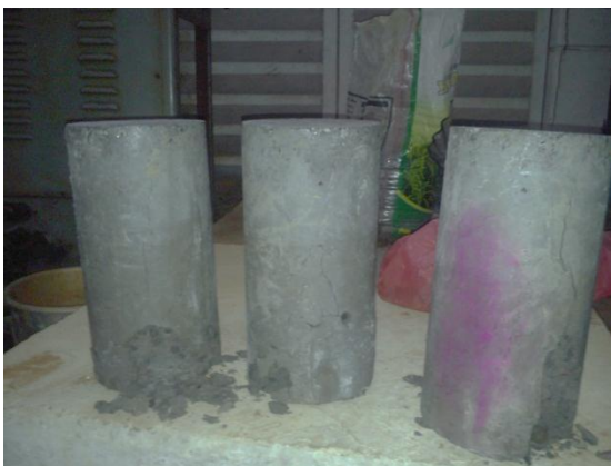
Pola retak Beton Mix 2 pada umur 28 hari (kiri) dan umur 91 hari (kanan)
