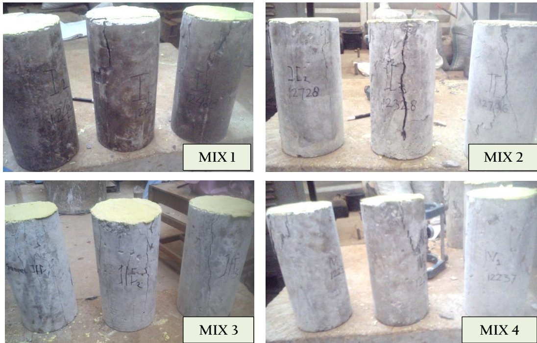
Gambar 4.7 Pola Retak pada Benda Uji Pengujian Kuat Tekan Umur 91 Hari
