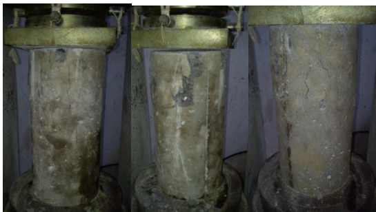
Pola retak Beton Mix 1 pada umur 28 hari (kiri) dan umur 91 hari (kanan)
