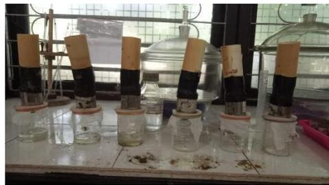
Pengujian laboratorium permeabilitas
