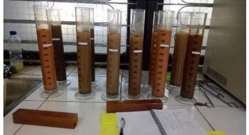
Pengujian laboratorium tekstur tanah
