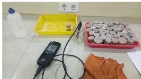
Pengujian laboratorium salinitas
