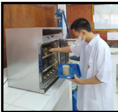
Gambar 5. Pengeringan Sampel Menggunakan Oven
