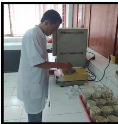
Gambar 7. Proses Penimbangan Sampel Setelah di Tanur
