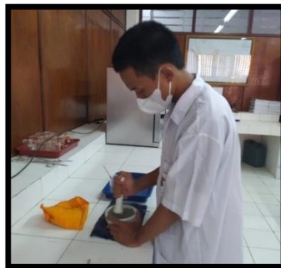
Gambar 6. Menghaluskan Sedimen yang telah melalui proses pengeringan
