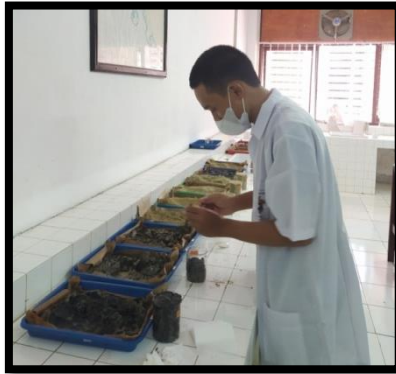
Gambar 4. Pengeringan Sampel Sedimen
