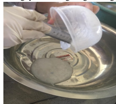
Pelarutan polistiren menggunakan aseton
