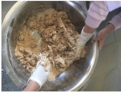
Pencampuran bahan partikel kayu dan polistiren
