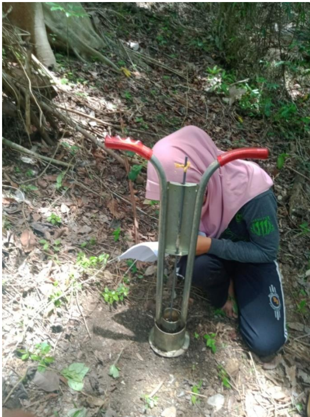
Gambar 9 . Pengamatan Penurunan Air
