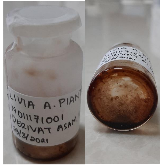
Gambar 31 Cairan cuci derivat asam kojik dengan etanol pro analysis hangat (yang telah dinetralkan)
