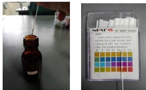
Gambar 14. Proses pengukuran pH ekstrak
