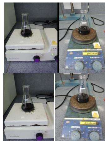
**Gambar 11. Proses ekstraksi alkali dari abu kulit buah kakao**
